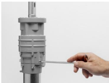
Le motoréducteur est doté d'un dispositif de déverrouillage mécanique actionnable par clé six pans. Le déverrouillage s'effectue par une rotation de 90° dans le sens des aiguilles d'une montre pour le côté A, et de 90° dans le sens contraire pour le côté B en faisant attention à ne pas forcer. Pour rétablir le fonctionnement automatique, effectuer la rotation en sens inverse.
