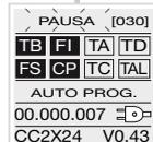
Appuyer sur "PROG" pour programmer le temps de pause souhaité. À ce stade, les vantaux s'ouvre lentement afin de pouvoir détecter la position d'ouverture complète.
